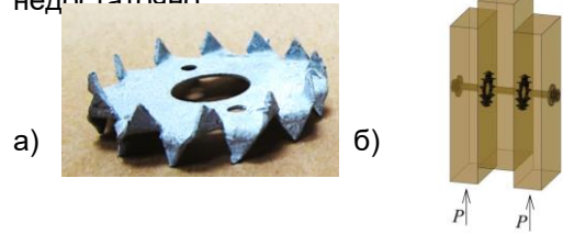
Рис. 1 - Когтевая шайба: а - внешний вид когтевой шайбы; б - принципиальная схема нагельного соединения с использованием когтевых шайб
