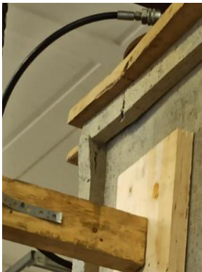
Рисунок 4- Первичные разрушения при испытании панели из фибролитовой плиты на сжатие в ИЦ СПбГАСУ
